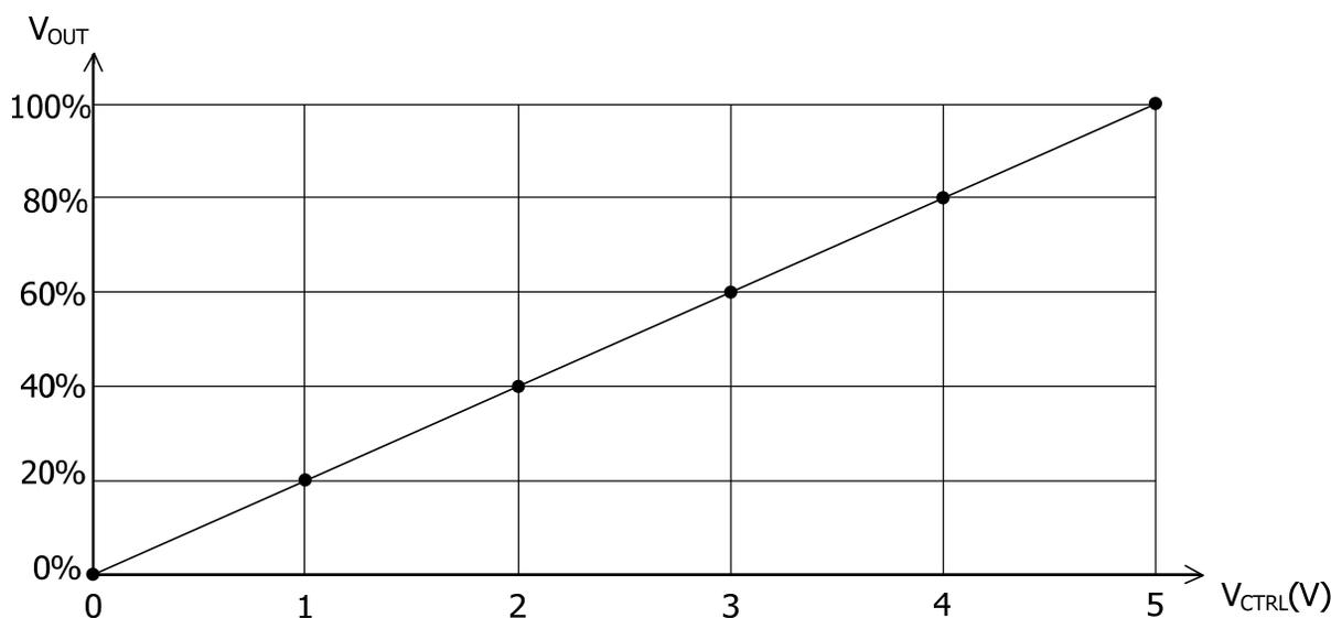
Figure 5. V<sub>CTRL</sub> vs. V<sub>OUT</sub>
