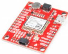
SparkFun GPS-RTK Board - NEO-M8P-2 (Qwiic)
